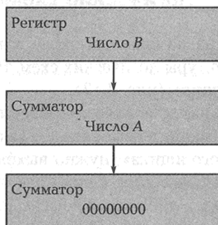
Рис. 3.11. Схема сложения двух чисел по mod2 с использованием сумматора
