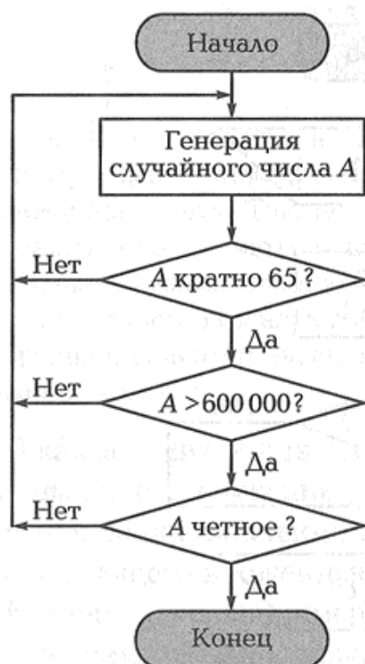
Рис. 2.30. Структурная схема циклического алгоритма: условие завершения — истинность трех условий
