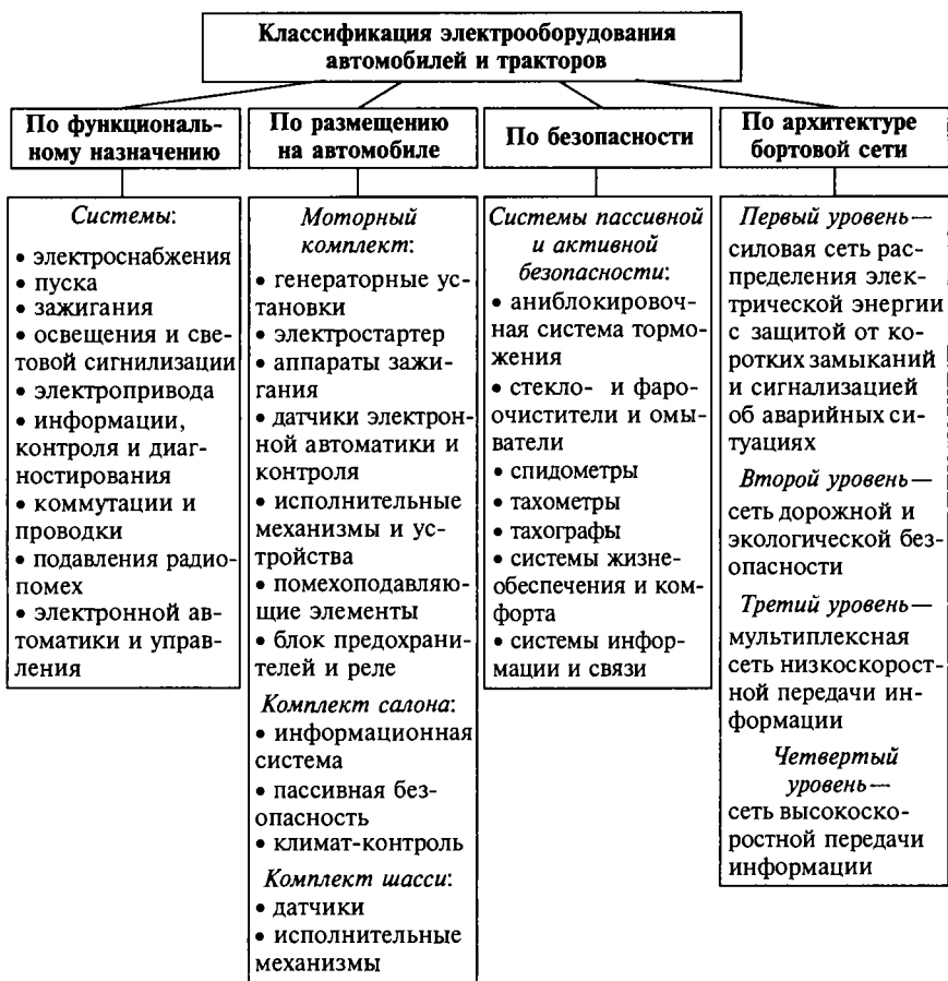
Рис. 1.2. Общая классификация систем электрооборудования автомобилей и тракторов
